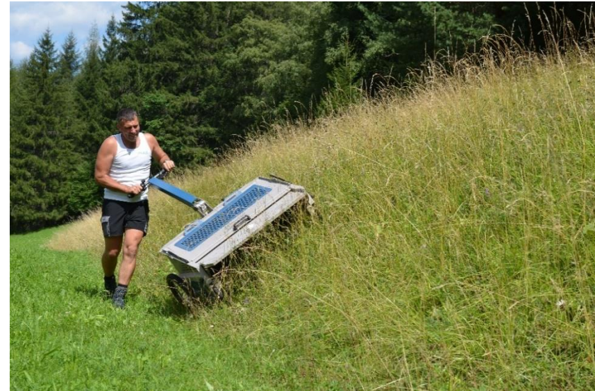
Mit speziellen Erntegeräten kann Wildpflanzensaatgut effizient aus dem stehenden Pflanzenbestand der Spenderfläche geerntet werden. Dabei wird durch rotierende Bürstenwalzen reifer Samen schonend abgestreift.
