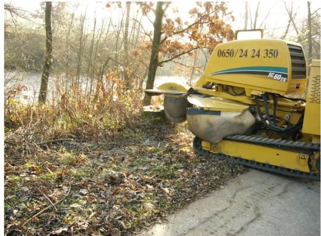
Links: Die Fräse hat eine Arbeitsbreite von bis zu 2,5 Meter und ist gegen Steine relativ unempfindlich. Stehendes Holz bis zu einem Durchmesser von 25 cm und Wurzelstöcke bis zu einem Durchmesser von einem Meter werden zerkleinert und in den Boden eingearbeitet. Fräsen können auf verschiedenen Geräteträgern montiert werden. Gut geeignet für Almen sind Schreitbagger, da dadurch auch eine punktuelle und kleinflächige Bearbeitung ermöglicht wird.
