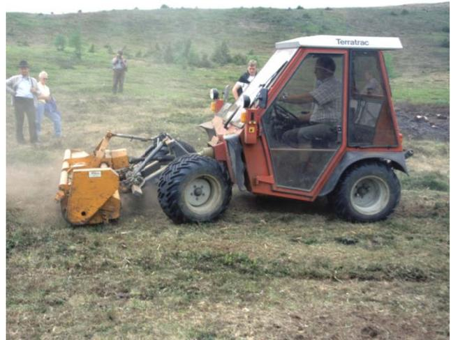
Mähtrak mit Schlägelmulch-Balken: Diese Form des Schlägeln ist sehr effizient auf Flächen mit homogenem Relief. Der Mähtrak ist auch auf steilen Hängen einsetzbar. Optimal einsetzbar sind diese Geräte auf steinfreien, wenig kuppigten Flächen mit Zwergstrauchheiden, brachliegenden Bürstlingrasen, verunkrauteten Flächen und Rasenschmielebeständen.
